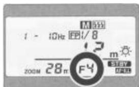
**4** Определите диафрагму и мощность вспышки в зависимости от расстояния до главного объекта съемки. Установите эти значения мощности и диафрагмы на SB-80DX.
