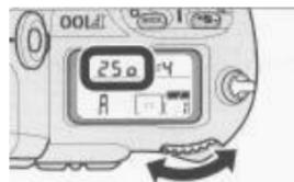
**6** Установите на фотокамере выдержку между 1/250 и 1/4000 сек (между 1/500 и 1/16000 для фотокамер серии D1).
