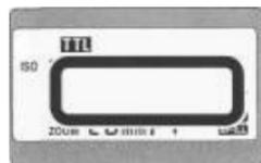
С ЖКИ дисплея исчезает индикация диапазона расстояний, если головка вспышки не установлена прямо вперед или не наклонена вниз на  $-7^\circ$ .
