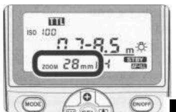
Текущая позиция зума головки вспышки высвечивается на ЖКИ дисплее.
